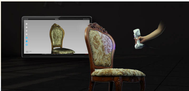
混合拼接(标记点, 纹理, 特征拼接智能融合) 复杂特征物品(局部存在无特征区域), 少量标记点即可扫描
